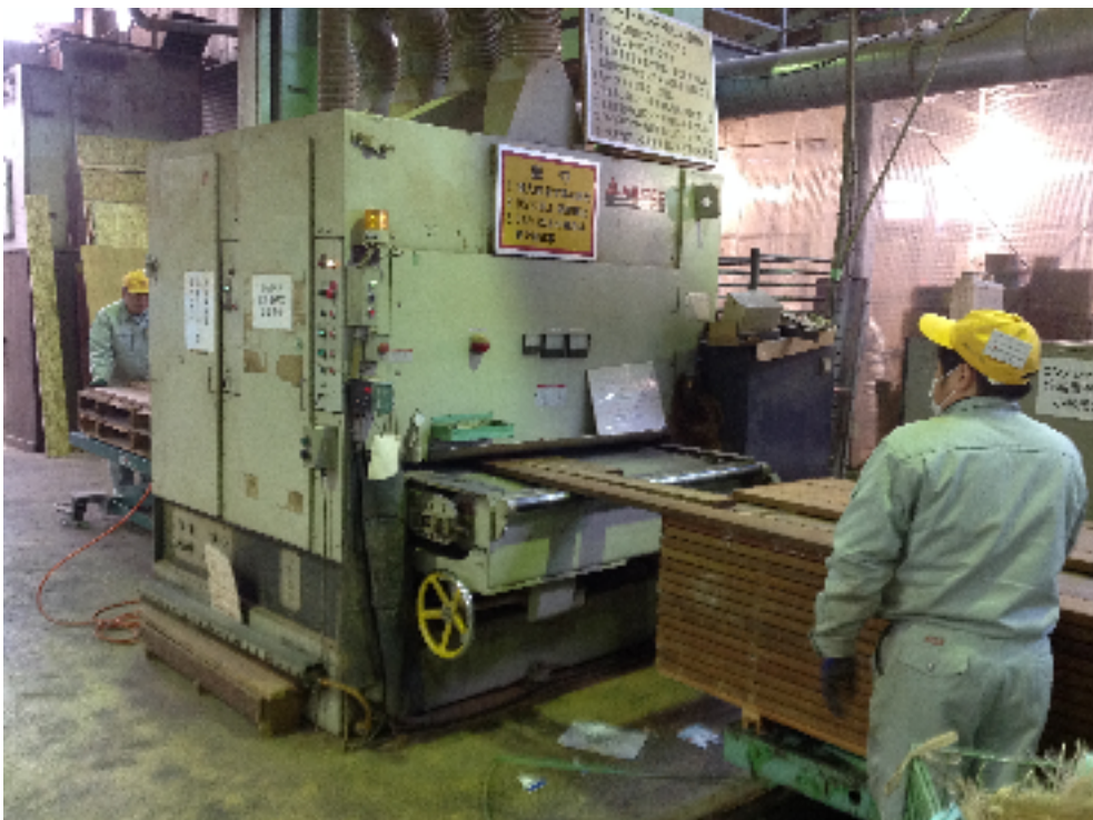
ワイドベルトサンダー（幅 1200mmまでのサンダー加工が出来ます）
