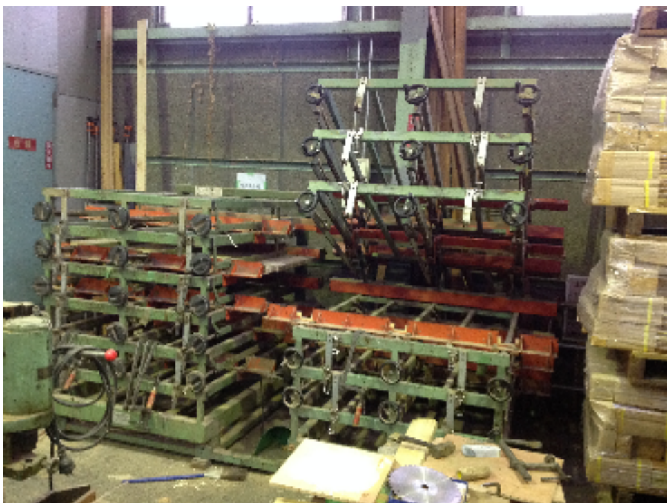
幅はぎ機（幅の狭い板を 1000mm幅まで接着できます）
