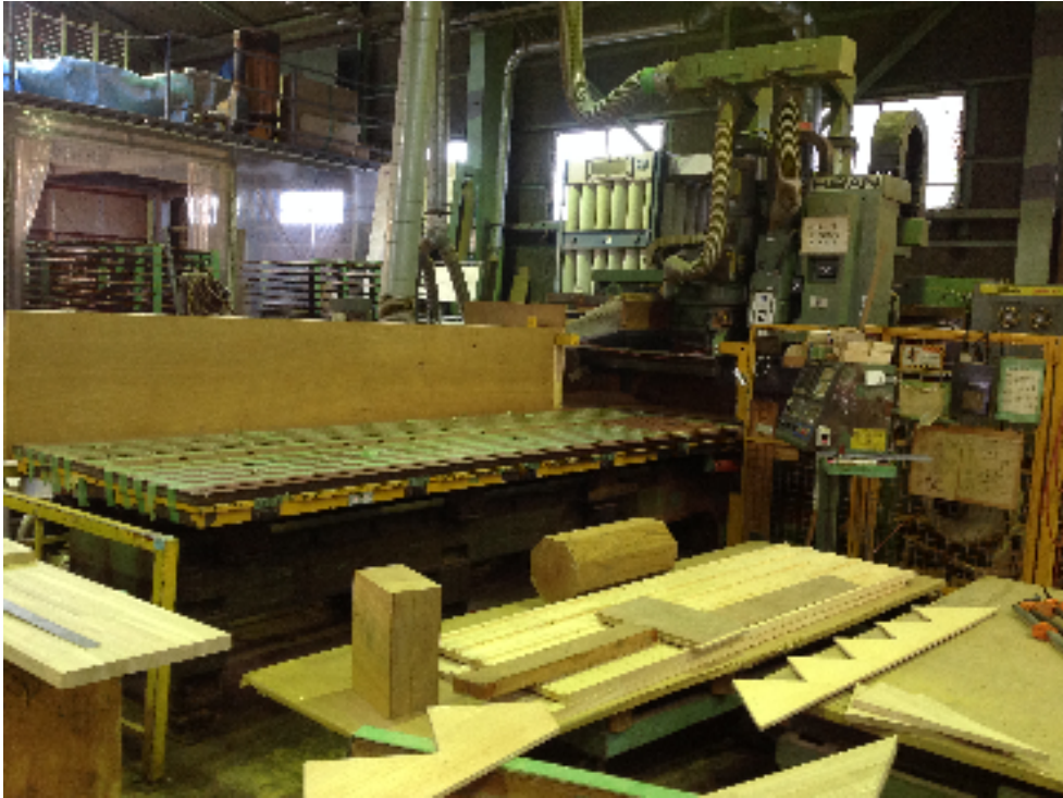
NCルーター（幅 1300mmまでの加工が出来ます）
