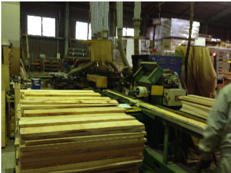
7軸モルダー（使用する材料の削り加工を行います）
