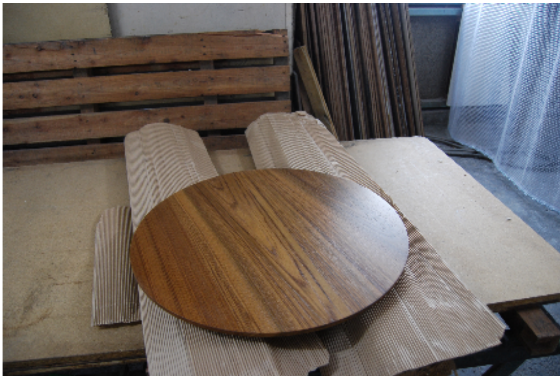
チーク材曲面切削のテーブル天板
