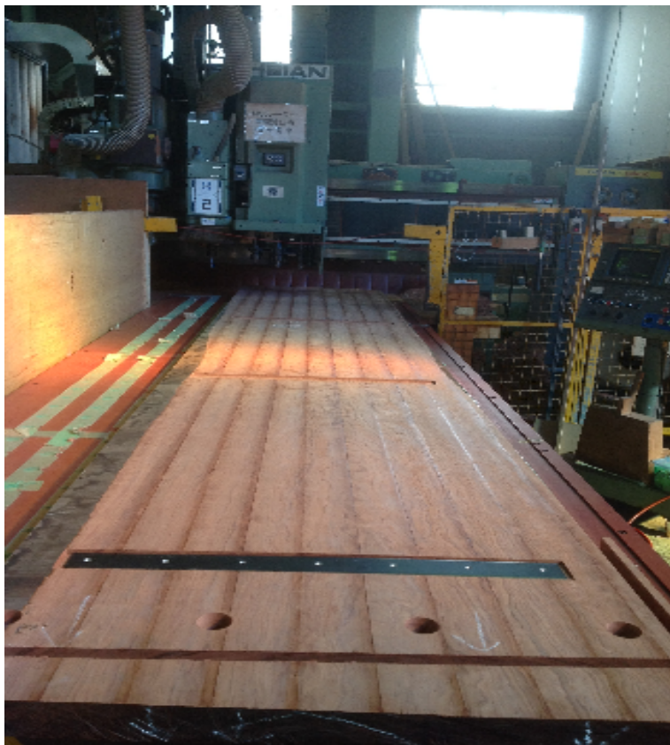
カウンター材の留め加工（ボルト加工）、穴あけ加工、面加工
