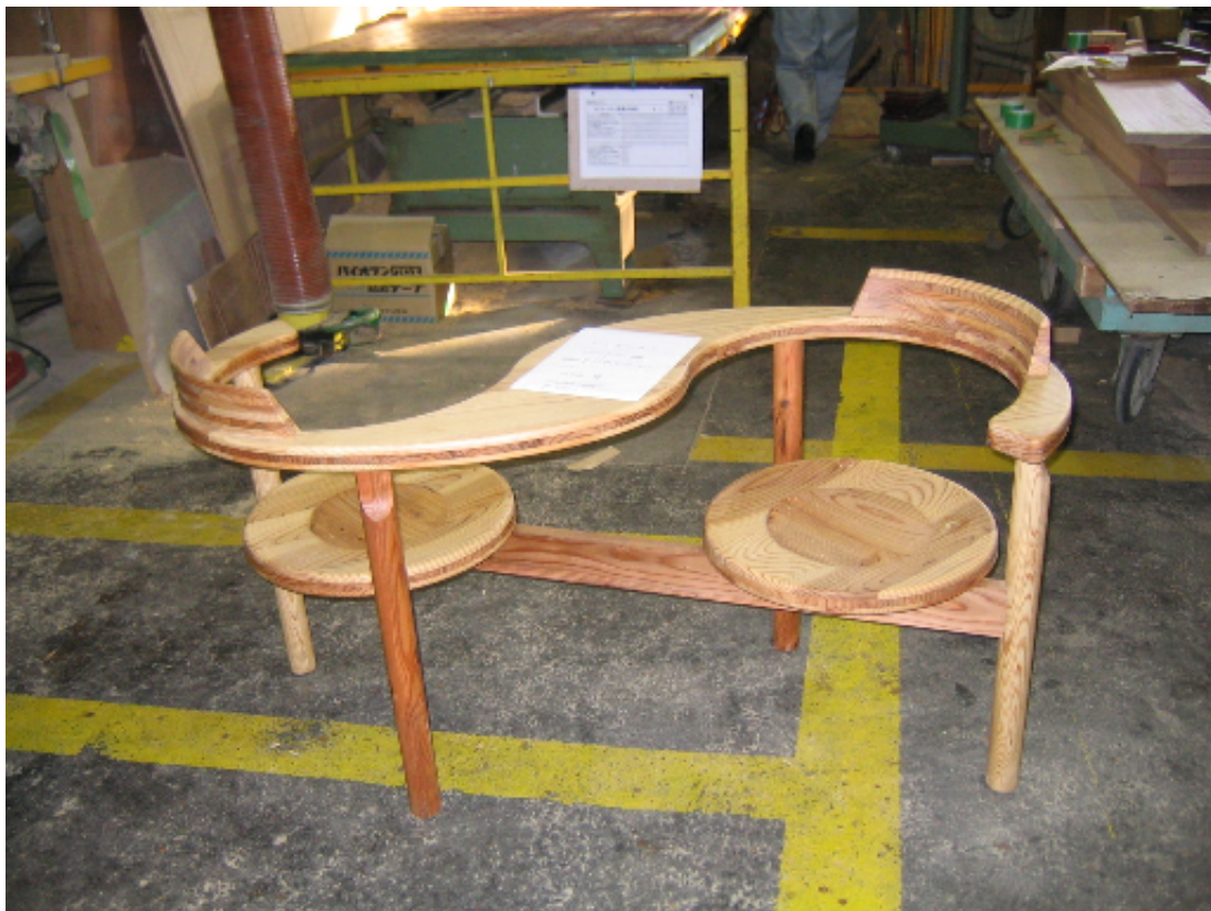
チーク材曲面切削のテーブル天板
