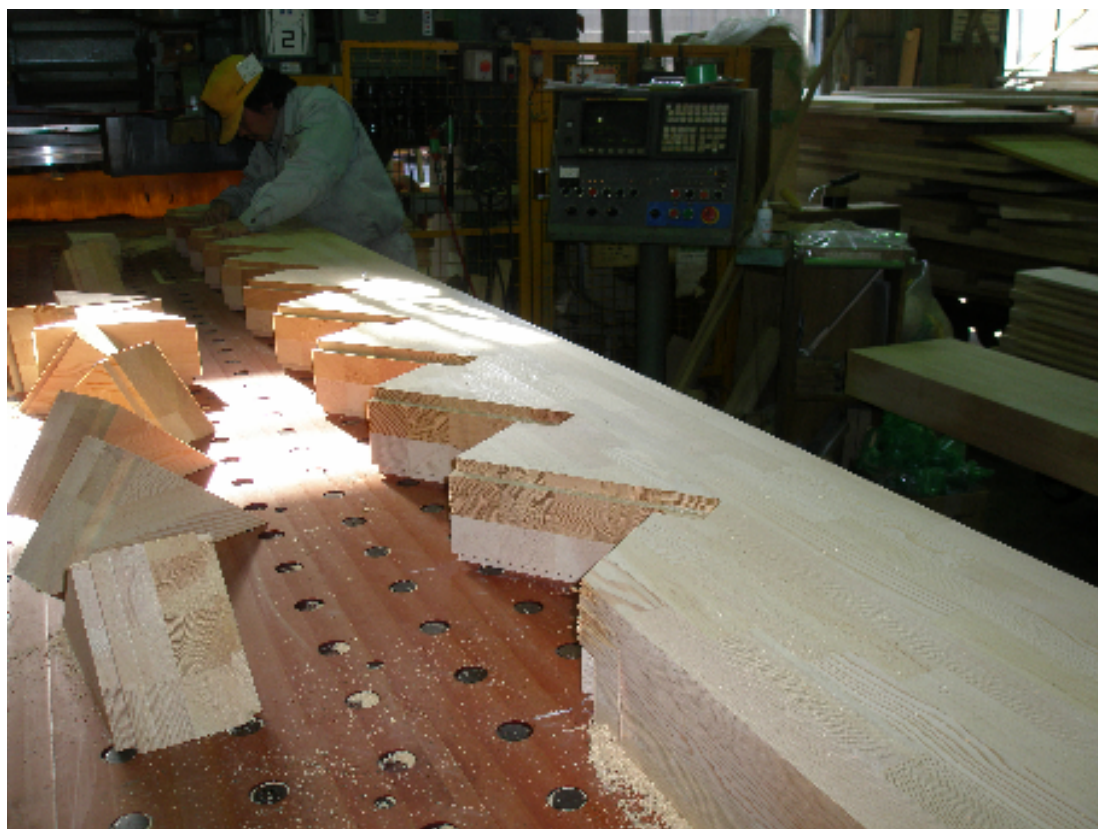
集成材階段厚板プレカット（ひな段）
