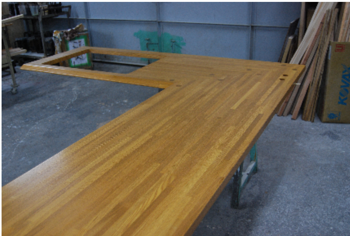
カウンター材の留め加工（ボルト加工）、穴あけ加工、面加工
