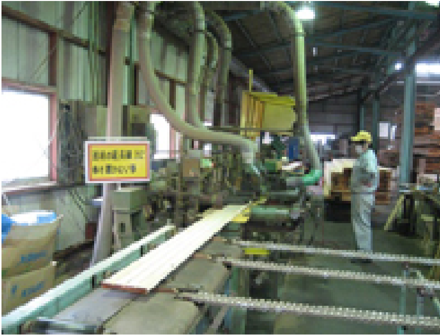
7 軸モルダーによる本実加工、
