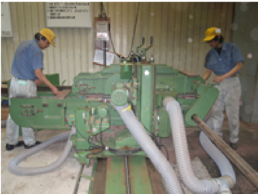
ダブルエンドテナーによるエンドマッチ加工
