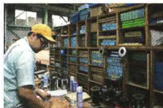
加工に必要な形状の刃物をすぐに選定してセットする
